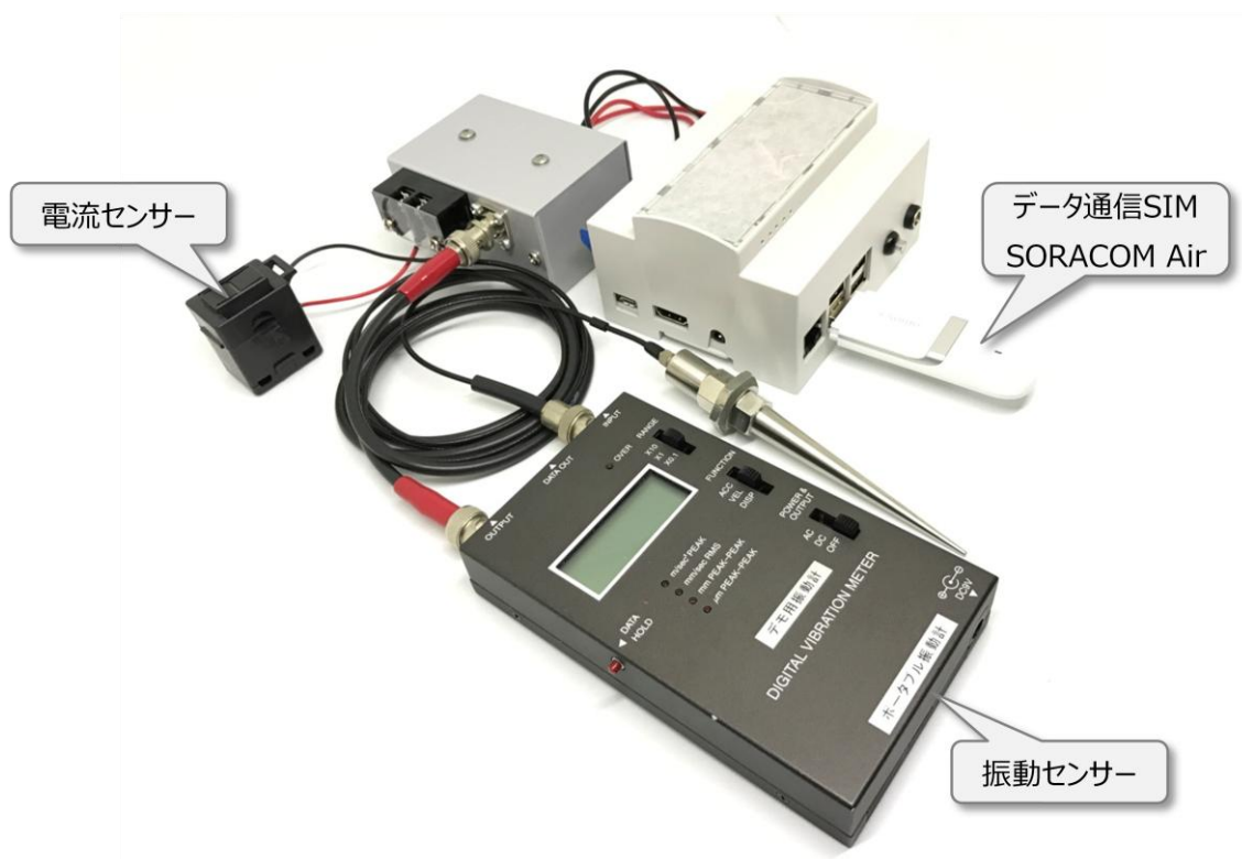
電流センサーと振動センサーの接続例
