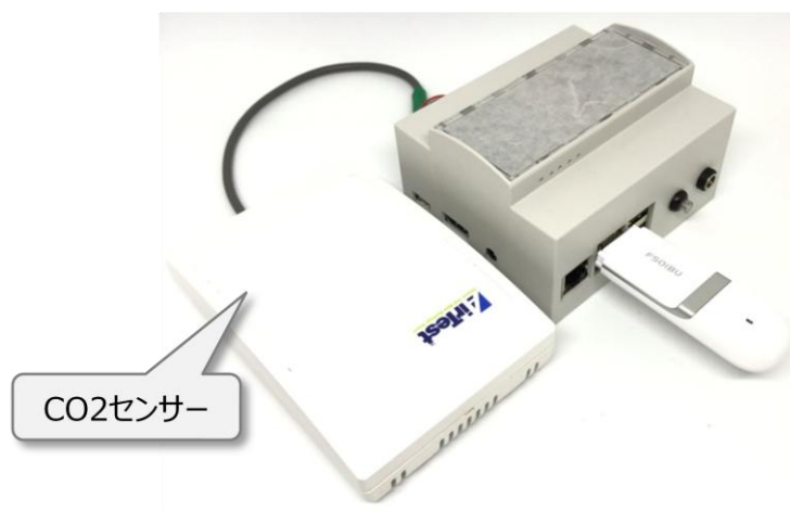
CO2 センサーの接続例
